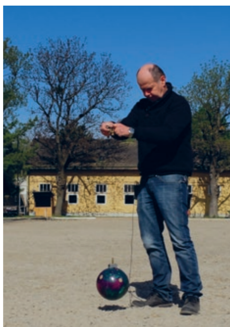
Johannes Schramel von der Universitätsklinik für Pferde testet die Elastizität von Reitböden.
