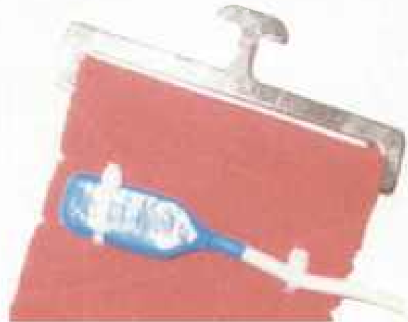
Abb. 4: Sensor des Accelerometers befestigt auf dem Deckengurt
